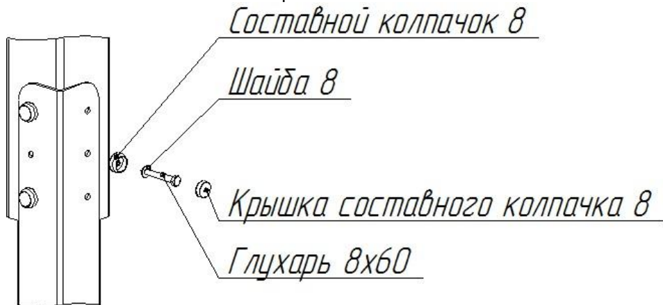
Рис.8. Схема установки стоек для бетонирования.
