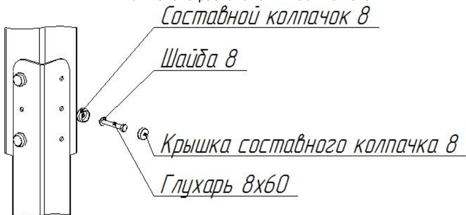
Рис.8. Схема установки стоек для бетонирования.
