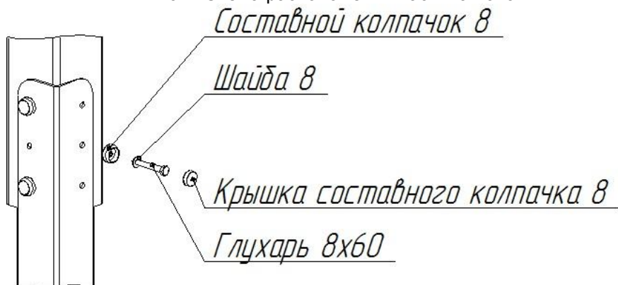
Рис.8. Схема установки стоек для бетонирования.
