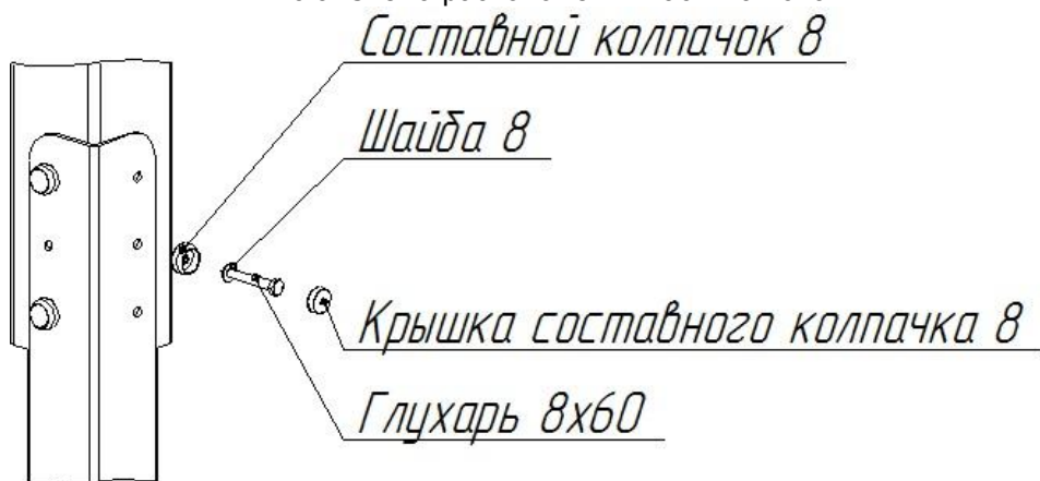
Рис.7. Схема установки стоек для бетонирования.
