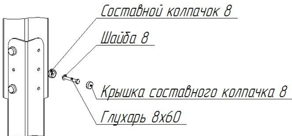
Рис.6. Схема установки стоек для бетонирования.
