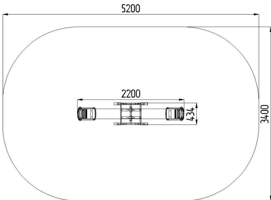
Рис.2. Схема зоны безопасности
